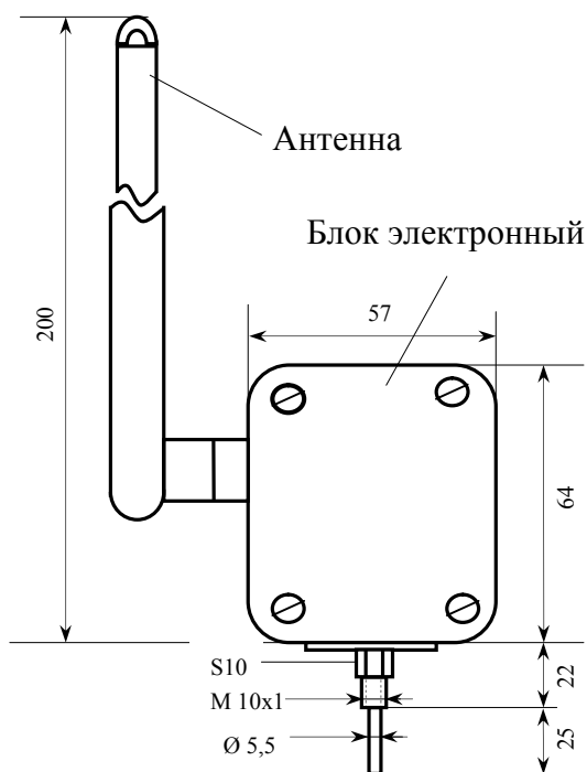
Рисунок 2 - Размеры термометра с аналоговым преобразователем Pt 1000 для труб малого диаметра или с цифровым преобразователем
